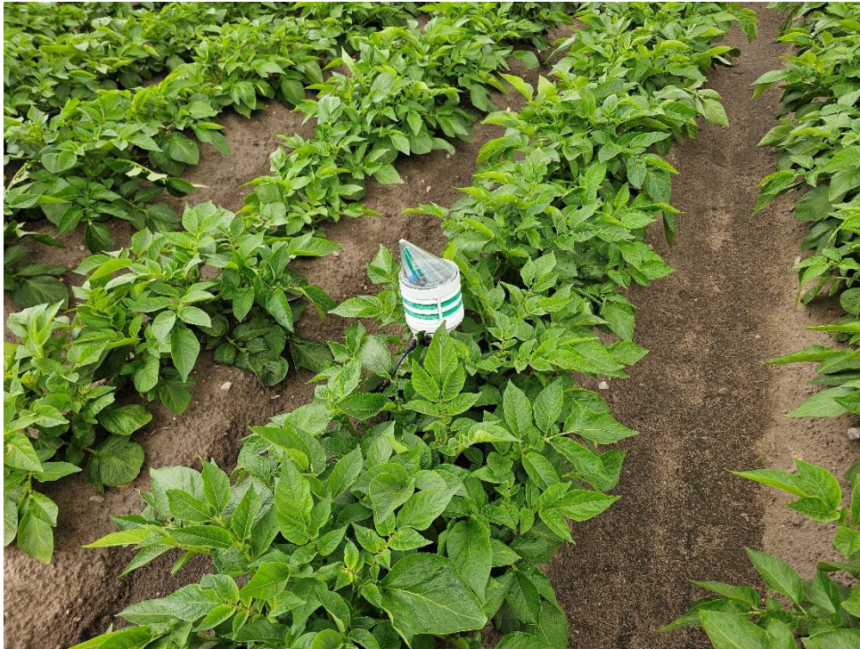
Digitale Werkzeuge in der Bewässerung: Durch Sensoren, die die Bodenfeuchte sowie das Bestandesklima erfassen, kann der Landwirt online auf die Werte zurückgreifen. (Foto: Dr. R. Peters)
