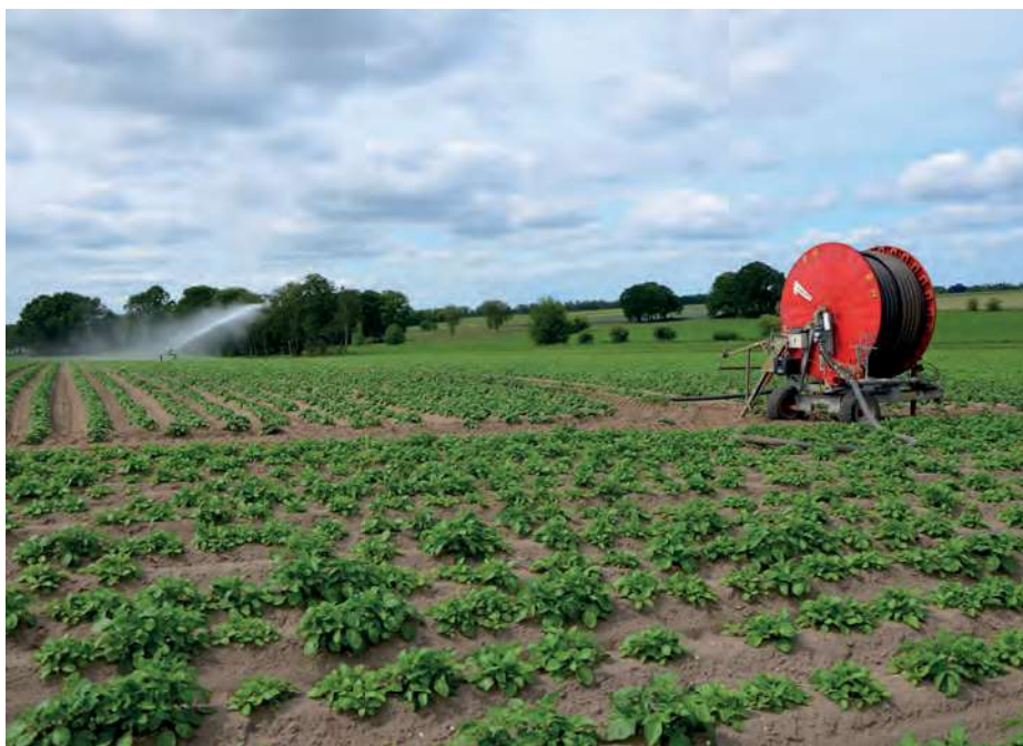
Für die Beregnung von Kartoffeln dominieren mobile Beregnungsmaschinen mit Starkregnern.
